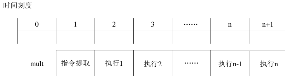
图表 6-3 乘法指令 mult 的执行过程
